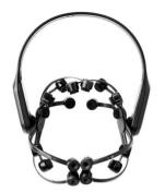
**Figure 2.** Emotiv Epoc portable EEG instrument.
