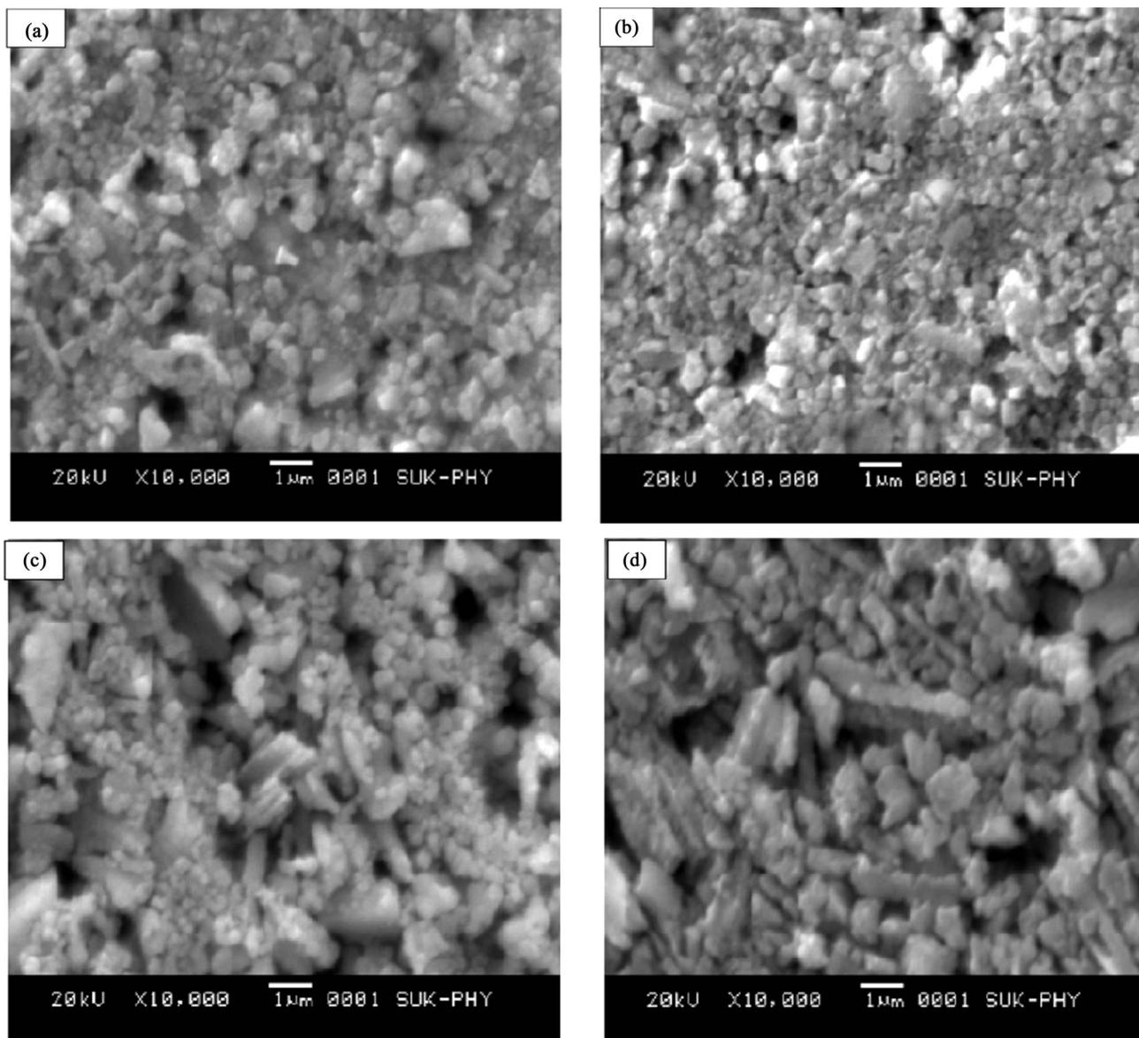
**Figure 3.** SEM of  $\text{Co}_3\text{O}_4$  thin films annealed at (a) 400°C, (b) 500°C, (c) 600°C and (d) 700°C.
