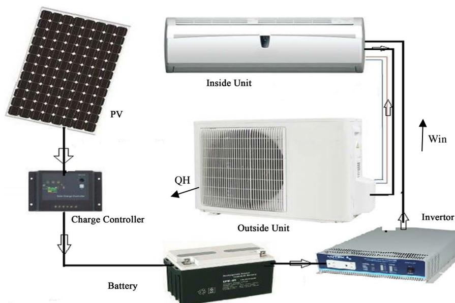
**Figure 3.** Final actual system cycle.
