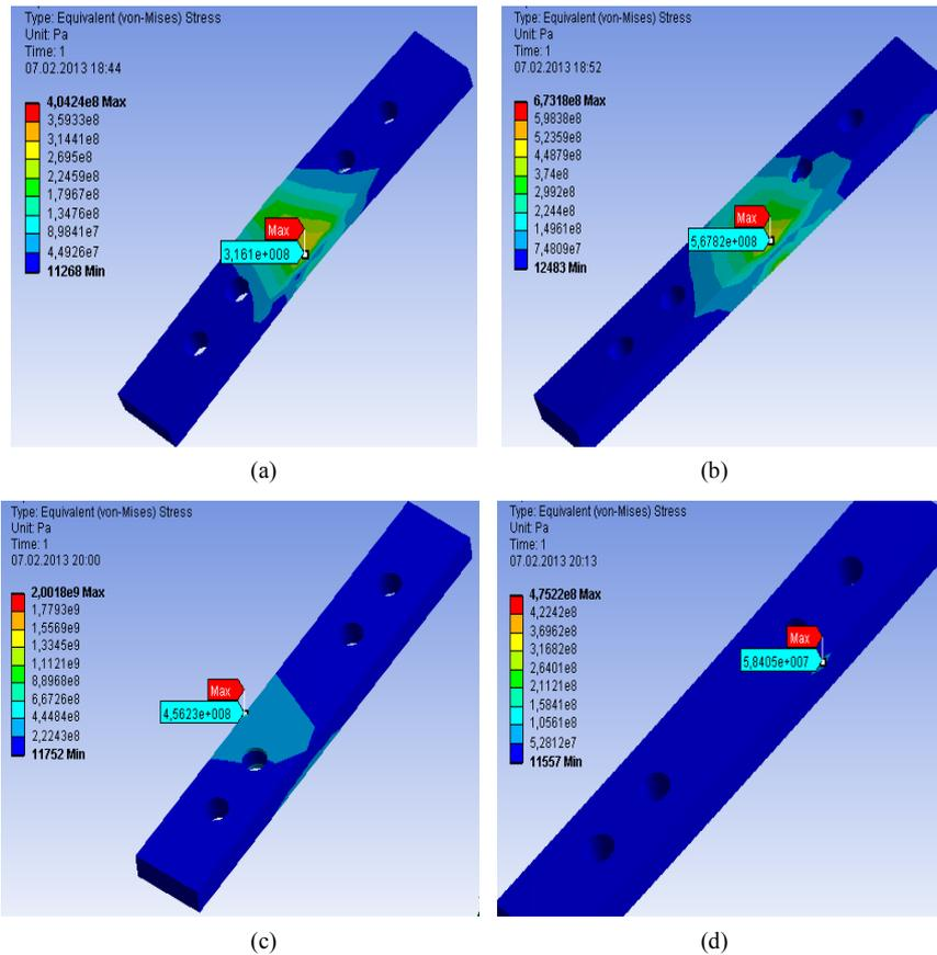
**Figure 6.** Contour plot for the maximum von Mises stresses (a) 0°; (b) 15°; (c) 30°; (d) 45°.
