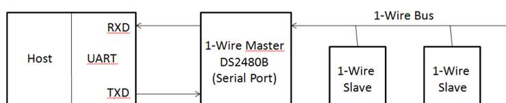
**Figure 6.** DS2480B simplified functional diagram.
