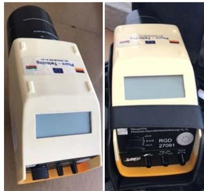
**Figure 2.** X-Ray-Gamma-Dosimeter RGD 27091.
