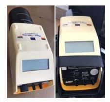
Figure 2. X-Ray-Gamma-Dosimeter RGD 27091.
