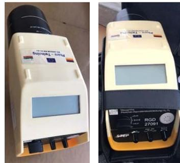
**Figure 2.** X-Ray-Gamma-Dosimeter RGD 27091.
