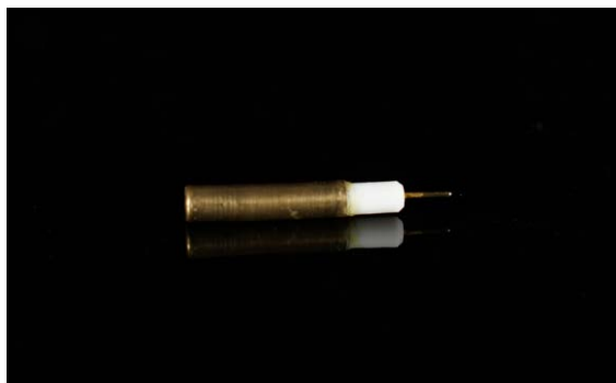
图 4. GJ4010 盖革管计数器
