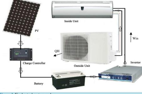
Figure 3. Final actual system cycle.
