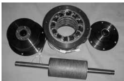
圖 9. 樣機定子、動子及端蓋圖
