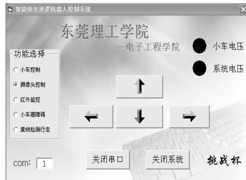
图 7. 监控中心软件界面
