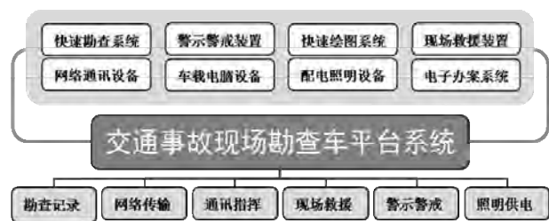
图 2. 交通事故现场勘查车的集成设备及其功能
