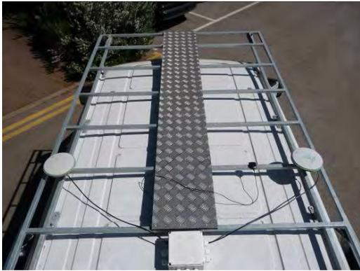
图 5. GPS 天线安装图
