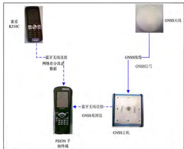
图 2. 终端用户系统示意图
