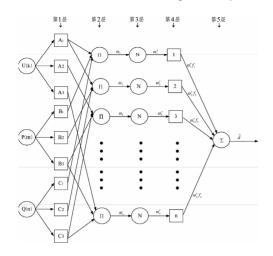
圖 1. 綜合負荷模糊神經網路模型結構圖 Figure 1. Load model structure of ANFIS
