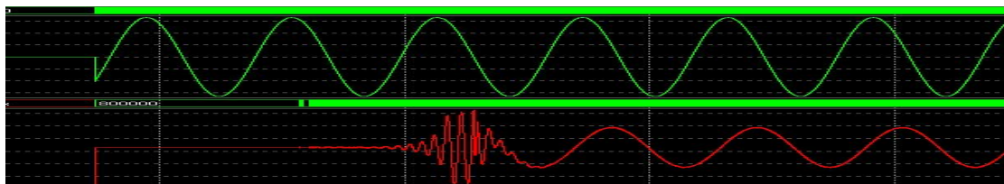
Figure5.the input and output of digital signal 图 5 经过 IIS 模数、数模转换
