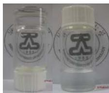
图 1 1% G<sub>2</sub>-C<sub>12</sub>-G<sub>2</sub> 的 MMA 凝胶
