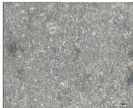
图 8 完好转子的金相组织图
