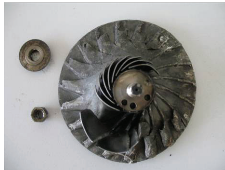
图 4 叶片损坏形貌
