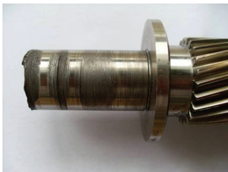
图 3 二级转轴表面磨损形貌
