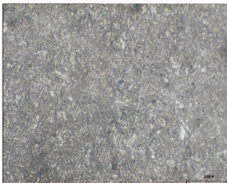
图 7 转子断口处金相组织
