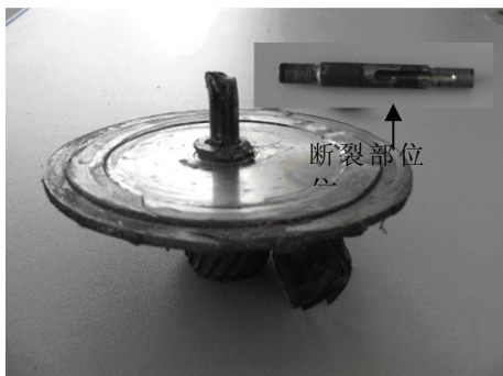
图 1 转子断裂部位
