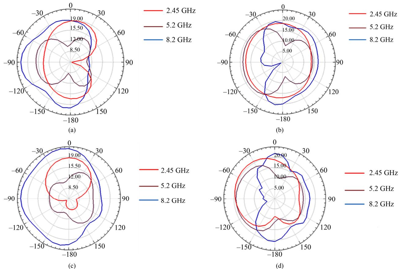
Figure 9. Farfield radiation patterns. (a) E-plane without LHM; (b) H-plane without LHM; (c) E-plane with LHM; (d) H-plane with LHM.
